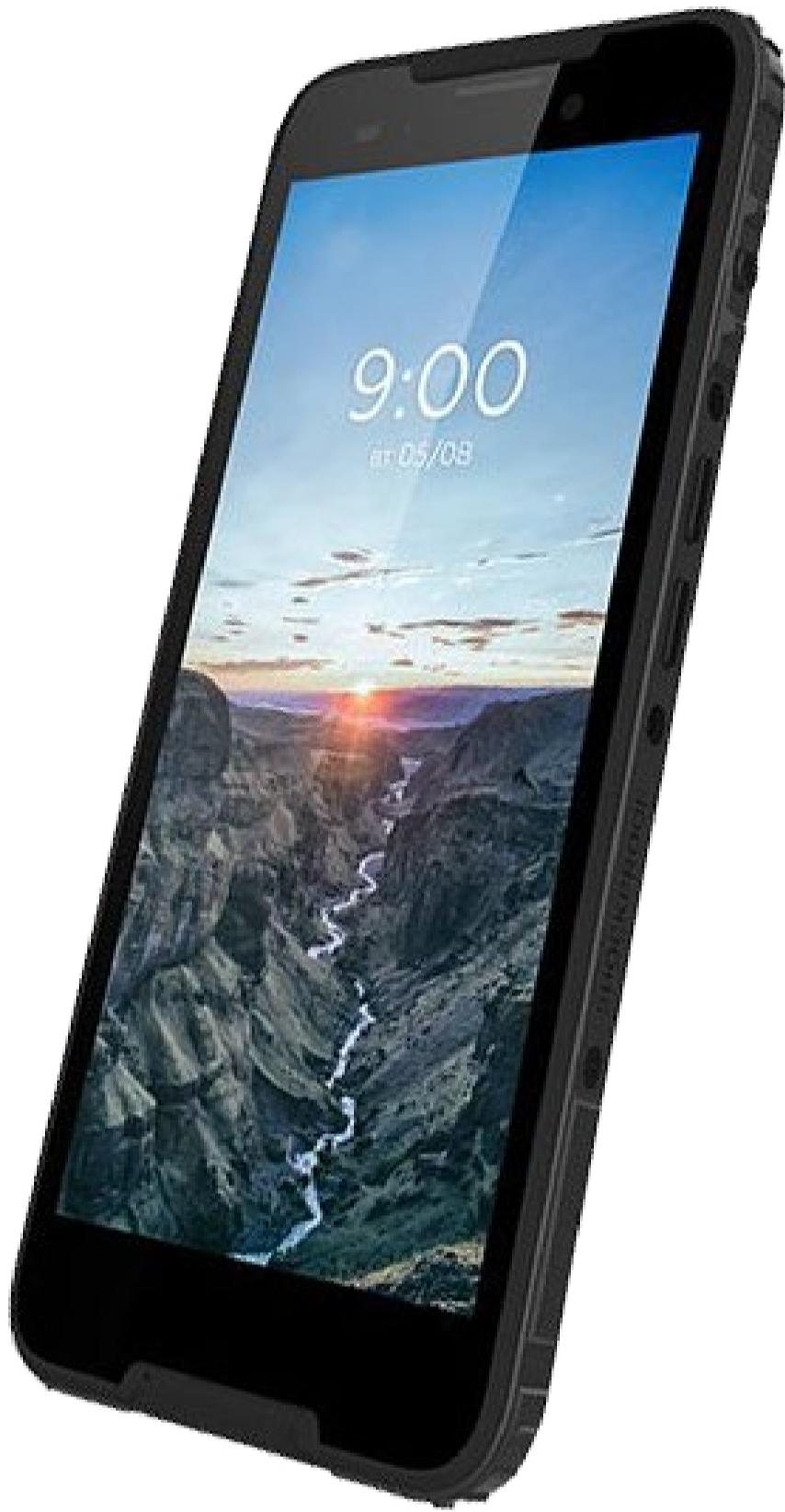
ников, так что если захотите послушать музыку, то Bluetooth вам в помощь. С другой стороны, разработчиков вполне можно понять — любая лишняя дырка на корпусе аппарата, пусть даже и заткнутая тщательно резиной — все равно потенциальная брешь в его водо- и пыленепроницаемых свойствах.
