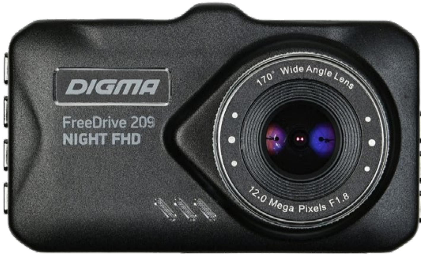
ясняется тем, что на видеорегистраторах стоит широкоугольный объектив только чтобы снимать происходящее прямо перед автомобилем, а фотокамера многофункциональная и ей требуется гораздо более сложный объектив. Оптика в фотокамере — самая сложная и дорогая часть, а не матрица с большим количеством мегапикселей, хотя матрица тоже важна.
