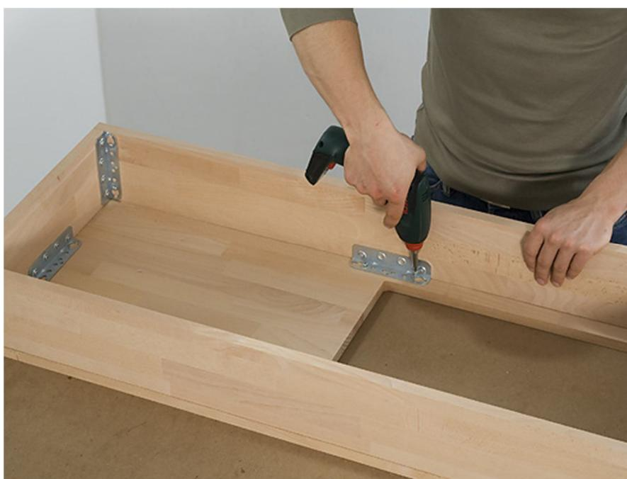
Уложите столешницу на рабочий стол лицевой стороной вниз. Выровняйте заподлицо на ней предварительно собранную раму. Теперь приверните остальные четыре крепёжных уголка по центру к четырём сторонам рамы и столешнице. Для монтажа используйте аккумуляторный шуруповёрт и шурупы с полукруглой головкой 4 x 15 мм.
