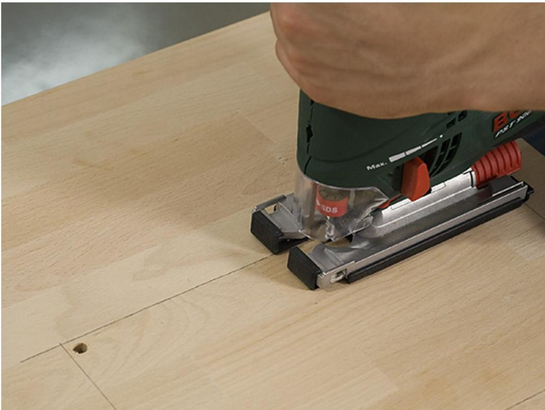
Начертите на столешнице карандашом прямоугольник размером 280 x 430 мм согласно указаниям на нашем чертеже. Просверлите по одному отверстию по углам прямоугольника с помощью дрели и сверла диаметром 10 мм. Кромки сверла должны только касаться линий, отмеченных карандашом, но не выходить за них!
