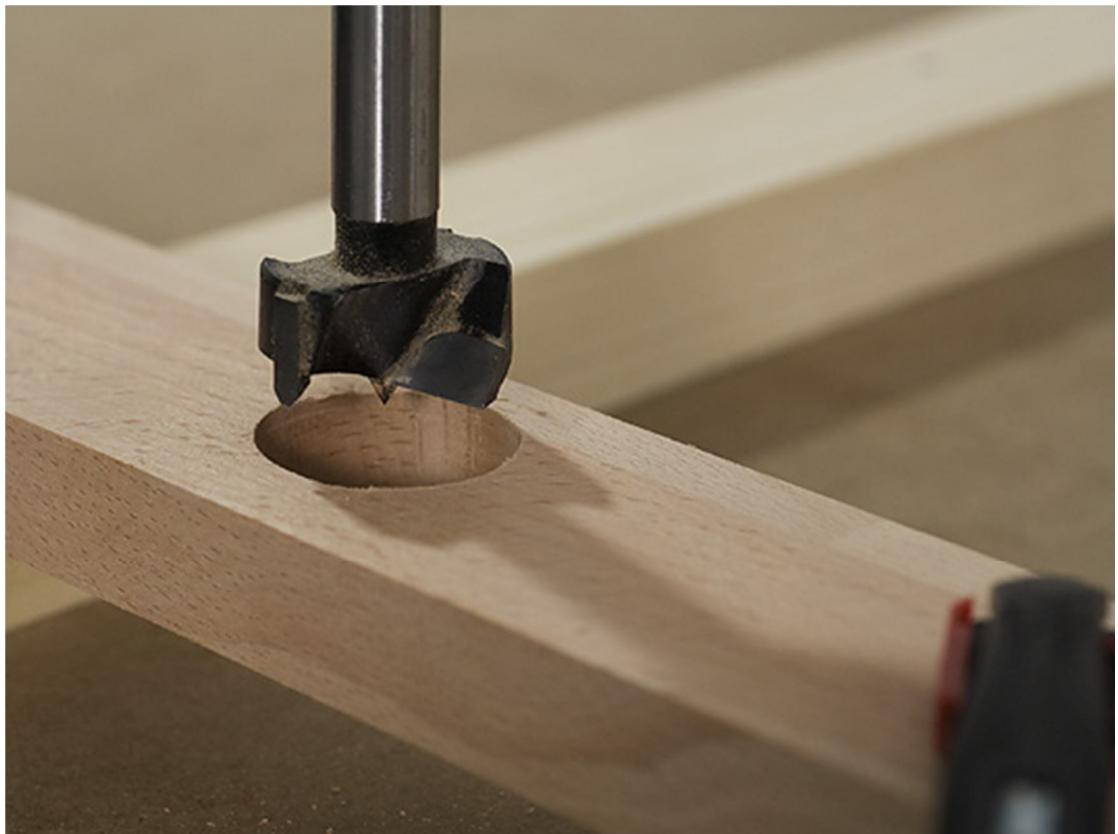
Просверлите отверстия (лучше всего выполнить это на плите, которую вы уже использовали при фрезеровании боковины ящика-подноса).
