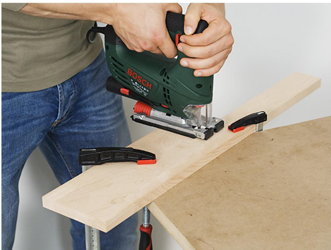
Укоротите сначала длину одну из опорных плит с 260 до 190 мм (если для ящика-подноса будет выбрана другая глубина, соответствующим образом подгоните длину).
