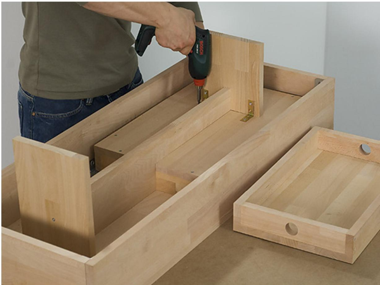
Сначала приверните к опорной конструкции восемь крепёжных уголков заподлицо с верхней кромкой. Приверните опорную конструкцию с помощью аккумуляторного шуруповёрта и шурупов 3 x 16 мм к столешнице.
