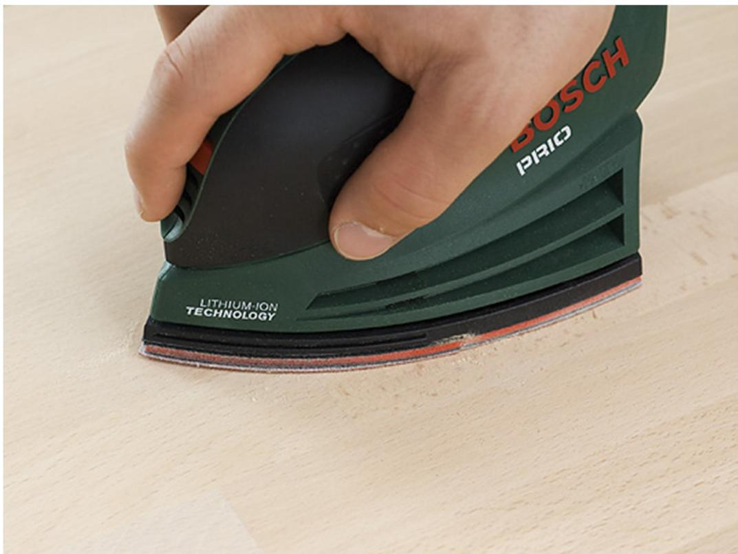
Сначала скруглите все кромки, используя шлифлист зернистостью 120 или 180, под углом 45° до образования небольшой фаски. Лицевые поверхности всегда шлифуйте шлифмашиной в направлении текстуры древесины сначала крупнозернистым (120, 180), затем — мелкозернистым (до 240) шлифлистом.
