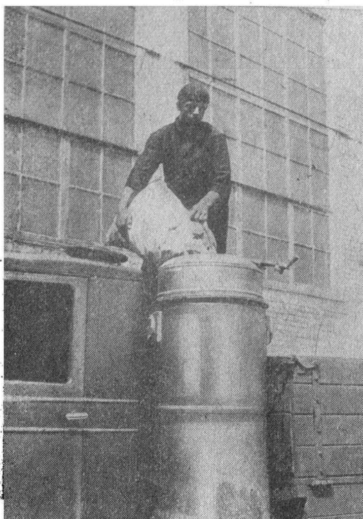
Рис. 26. Загрузка газогенератора топливом.
