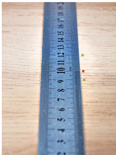
Фото 1. Глубина резко изображаемого пространства при диафрагме f6,3 .
