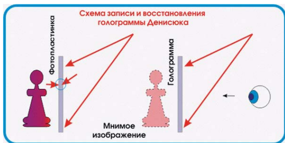
Рис. 4. Схема получения голограмм по методу Денисюка.
