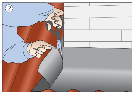
Надрезать верхнюю часть ленты в нижнем углу трубы
