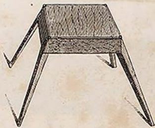
▲ Пирамидальный стол для устранения качания от действий рук, положенных на столешницу. litfund.ru
