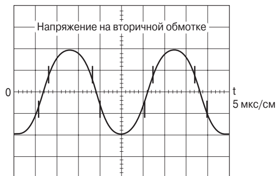
Рис. 18.12. Напряжение на вторичной обмотке трансформатора
