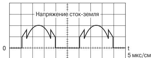
Рис. 18.7. Импульсы напряжения сток-земля транзисторов Q1 и Q2
