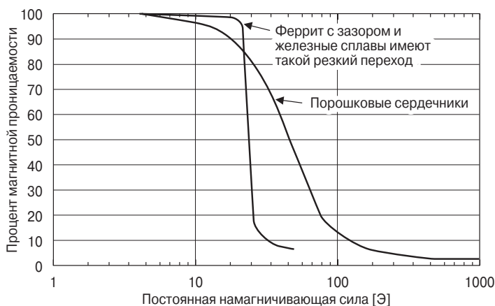
Рис. 15.7. Сравнение кривых спада магнитной проницаемости различных сердечников при их подмагничивании постоянным током
