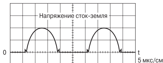
Рис. 18.8. Импульсы напряжения сток-земля транзисторов Q1 и Q2
