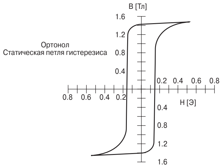
Рис. 2.5. Ортонол, B(H) : 50% Fe, 50% Ni
