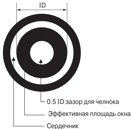
Рис. 4.12. Эффективная намоточная площадь тороидального сердечника
