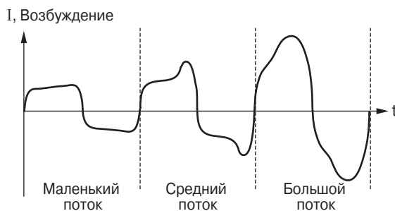
Рис. 1.37. Формы импульсов возбуждающего тока при различных плотностях потока B
