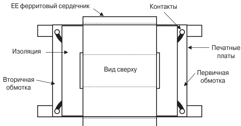
Рис. 20.3. Типичный планарный ЕЕ-трансформатор (вид сверху)
