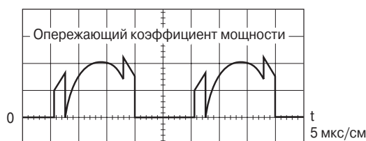
Рис. 18.9. Импульсы напряжения сток-земля транзисторов Q1 и Q2
