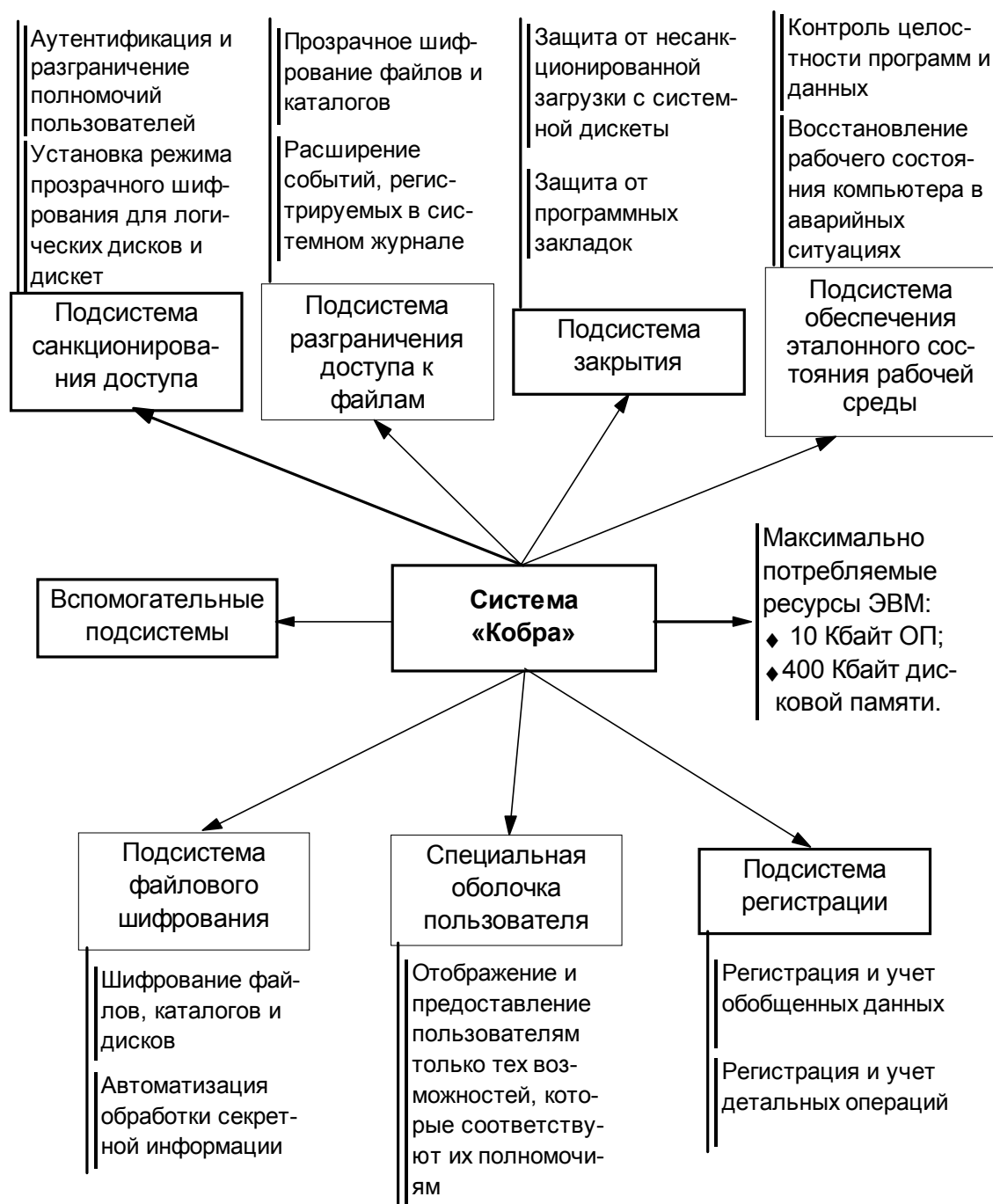
Рис. 1.2. Структура системы «Кобра» и назначение основных компонентов
