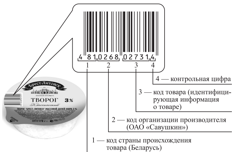
Рис. 2.8. Структура штрихового кода EAN-13
