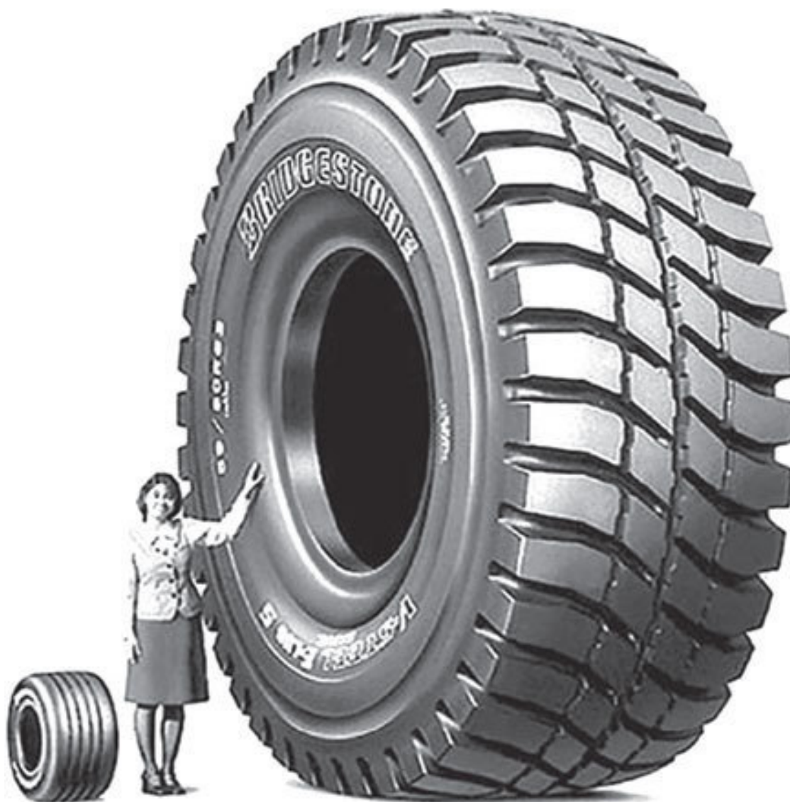
Рис. 31. Шина большого диаметра, ее размеры впечатляют: высота – 4,02 м, ширина – 1,47 м, вес – 5,1 т.
