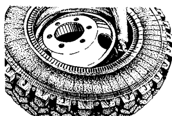
Рис. 5-15 Установка вентиля в паз
