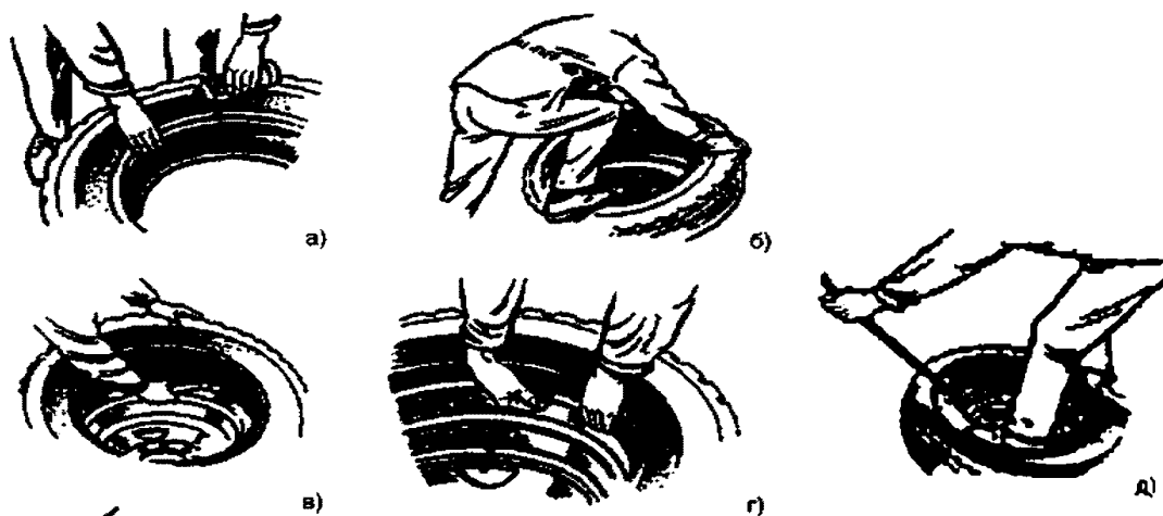
Рис. 5-18 Ручной монтаж бескамерной шины на колесо
