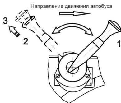
Рис. 2-6 Кран стояночного тормоза
