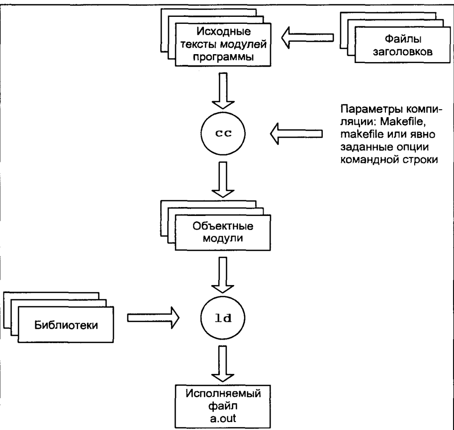
Рис. 2.2. Схема компиляции программы
